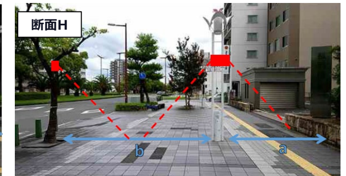
断面Hは計測面のカバー率が比較的高く、全体的に計測誤差が少ない。
