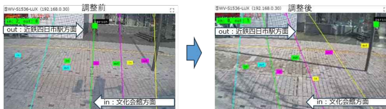
AIカメラ smp1の検知ライン調整の例
